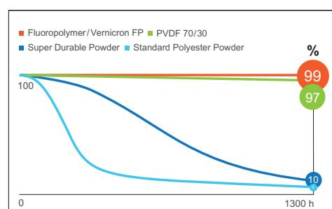
Fluoropolymer: perfekte Glanzbeständigkeit
